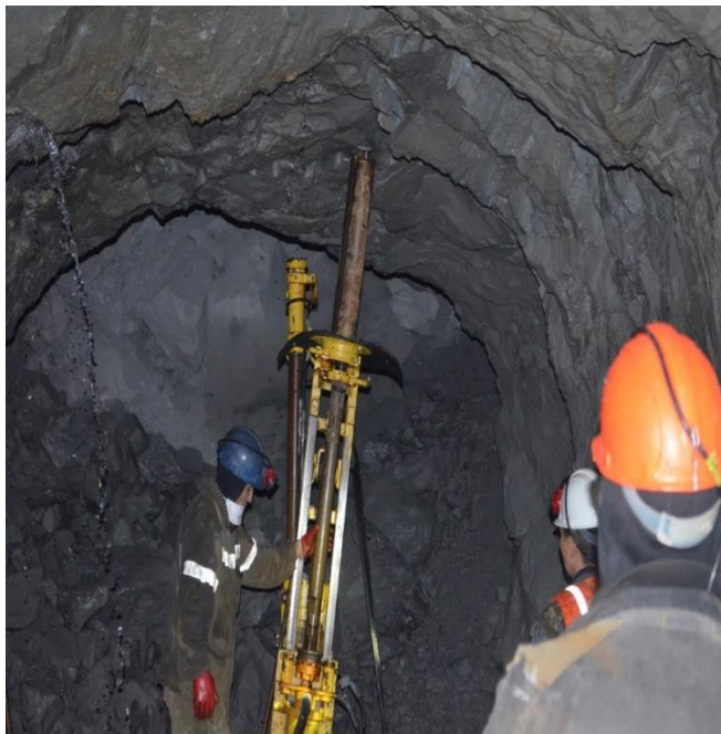
Рисунок 3.7 – специальное приспособление для бурения скважин диаметром 65 мм и 110 мм.
