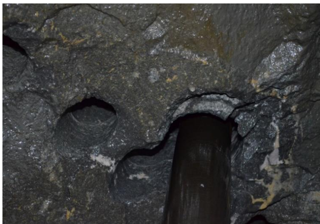
Рисунок 3.8 - Образование врубовой полости бурением сопряженных скважин
