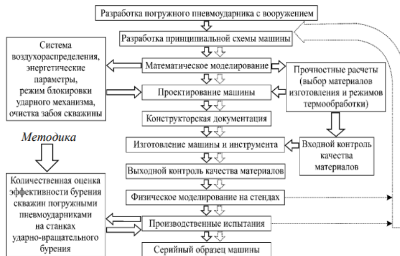
Рисунок 4.1 - Схема повышения эффективности бурения скважин с расширением их диаметра
