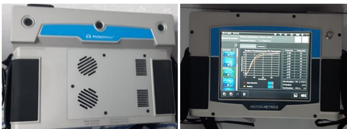
Рисунок 3.16 - Прибор для измерения фрагментации взорванной горной массы «PortaMetrics» серийный номер PM2136
