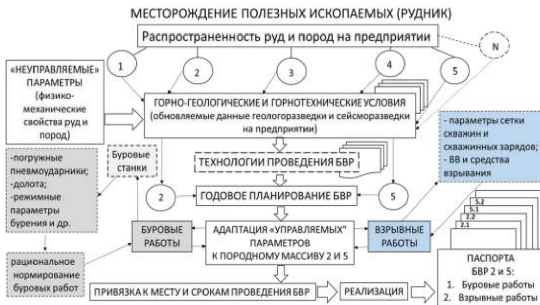
Рисунок 4.2 - Схема повышения энергоэффективности добычи полезных ископаемых в рудниках при бурении скважин с расширением их диаметра
